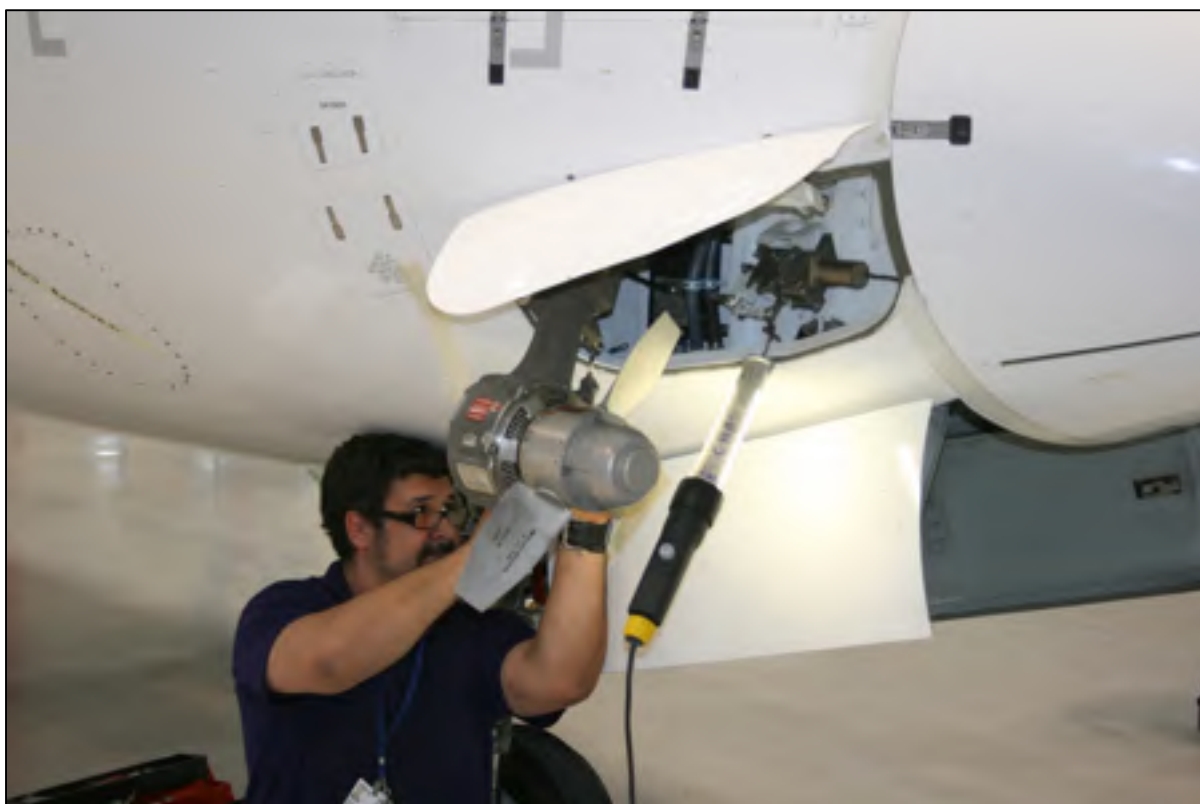
Figure 2.4 Assemblage RAT de la gamme Bombardier CRJ Tirée de Airliners.net
