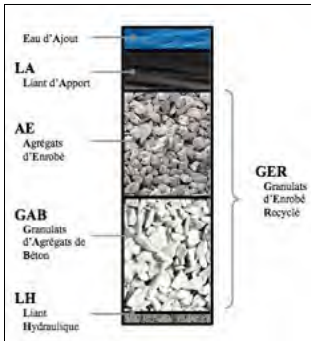
Figure 1.5 Composition d'enrobé recyclé de type MR5 traité à l'aide d'une émulsion de bitume à sa mise en place (sans vide)
