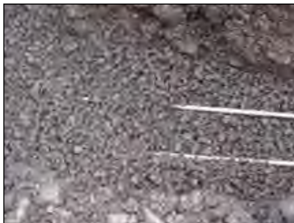
Figure 3.8 Recouvrement de la sonde avec le matériau de confinement (fraction 0/5 de MR5-TFE)
