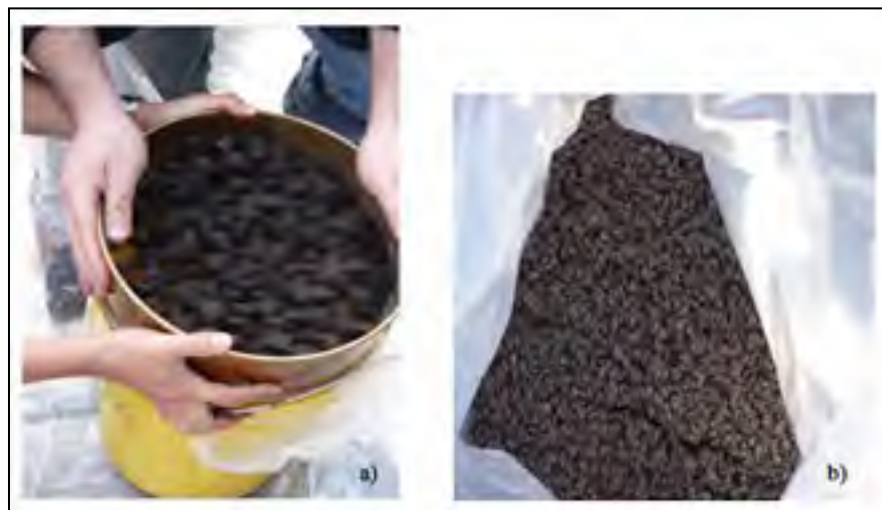
Figure 3.3 a) Tamisage du matériau MR5-TFE en chantier; b) Fraction 0/5 du matériau MR5-TFE tamisé
