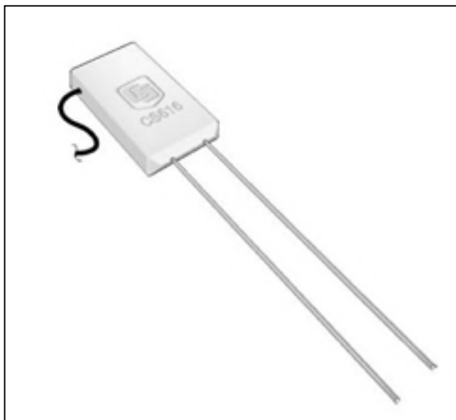
Figure 1.12 Sonde WCR de type CS616 développée par Campbell Scientific, Inc. Tiré de Campbell Scientific, Inc. (2006)
