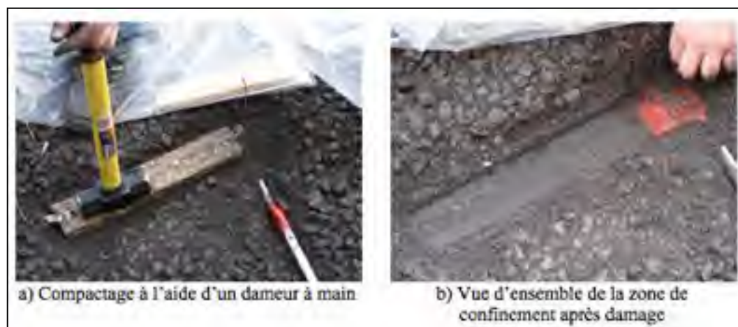
Figure 3.9 Compactage de la zone de confinement après mise en place de la sonde d'humidité
