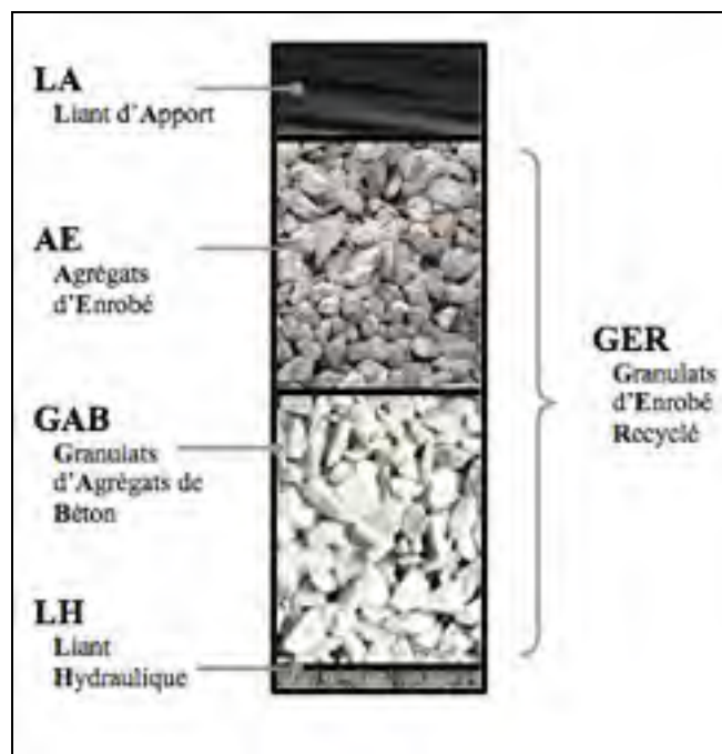
Figure 1.6 Composition d'enrobé recyclé de type MR5 traité à l'aide d'une émulsion de bitume après mûrissement (sans vide)
