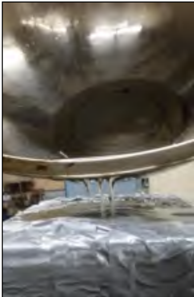
Figure-A II-3 Application de la cire de paraffine fondue sur l'éprouvette préalablement scellée par un film plastique
