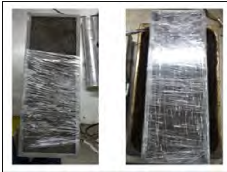
Figure-A II-1 Application d'un film plastique en guise de premier isolant autour de l'éprouvette fraîchement confectionnée
