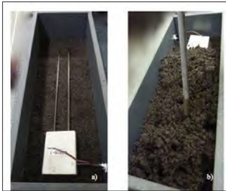
Figure-A I-2 a) Mise en place de la sonde sur la première couche compactée ; b) Compaction de la deuxième couche à l'aide d'un bourroir pour limiter la formation de vides
