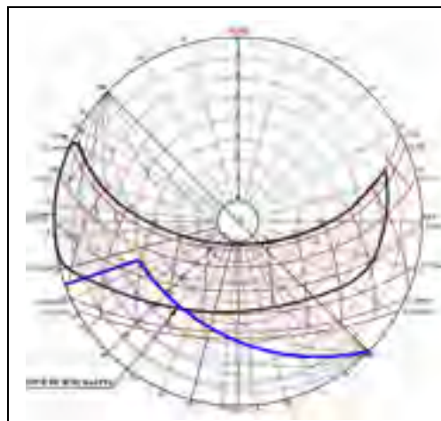
Figure 3.20 Masque d'ombre de la protection solaire de la paroi transparente Sud-Ouest
