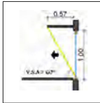
Figure 3.18 Profondeur requise d'un auvent d'une façade sud
