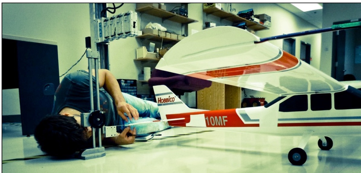
Figure 3.2 Mesure du débattement des surfaces de contrôle
