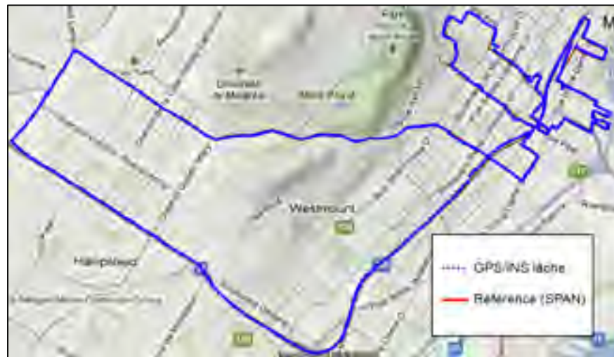
Figure 7-32 Trajectoire calculée à l'aide du modèle d'intégration GPS/INS par couplage lâche en environnement difficile
