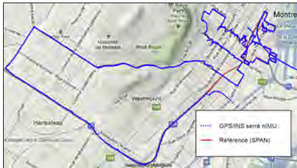
Figure 7-52 Trajectoire calculée à l'aide du modèle d'intégration GPS/INS par couplage serré à faible coût en environnement difficile
