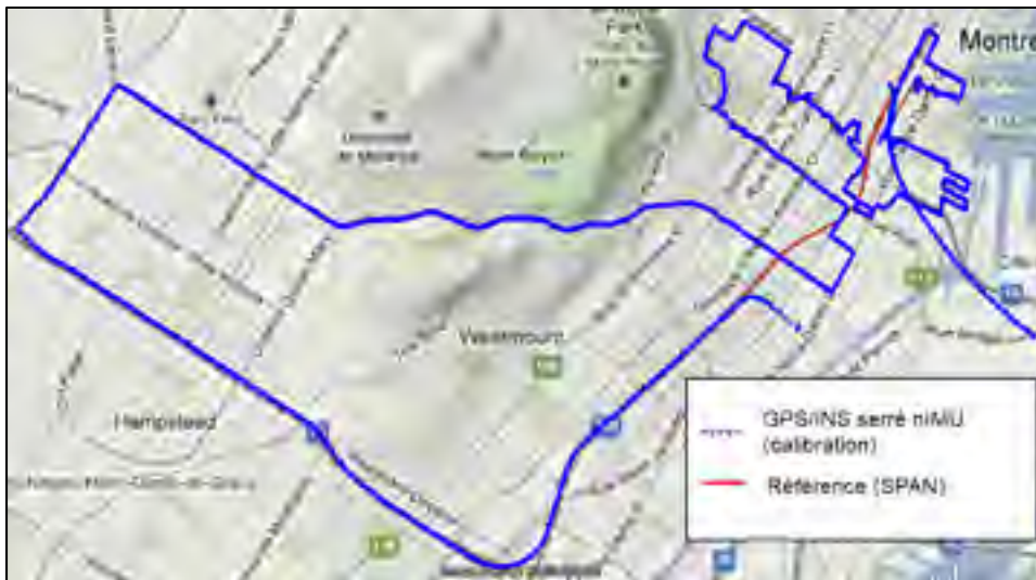
Figure 7-60 Trajectoire calculée en tenant compte des paramètres de calibration des capteurs inertiels à faible coût
