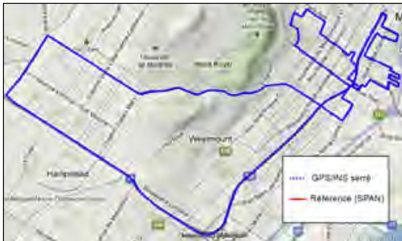
Figure 7-45 Trajectoire calculée à l'aide du modèle d'intégration GPS/INS par couplage serré en environnement difficile.
