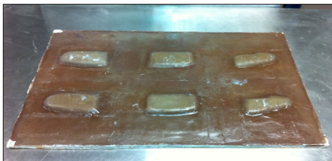
Figure 3.10 Structure du moule en fibres de verre mats/polyester pour la fabrication des nervures
