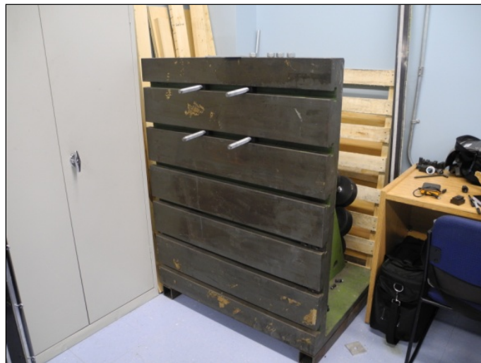
Figure 4.1 Table de montage utilisée pour la fixation du gabarit de test
