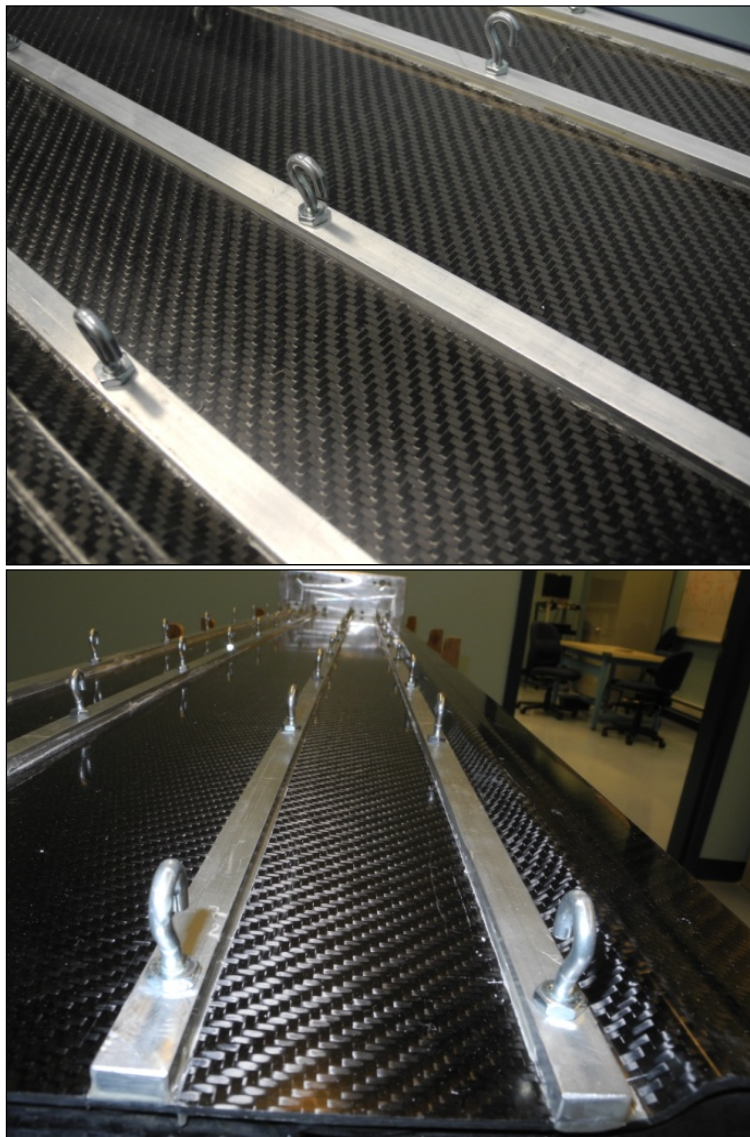
Figure 3.42 Résultats finaux du collage des lignes d'applications des chargements
