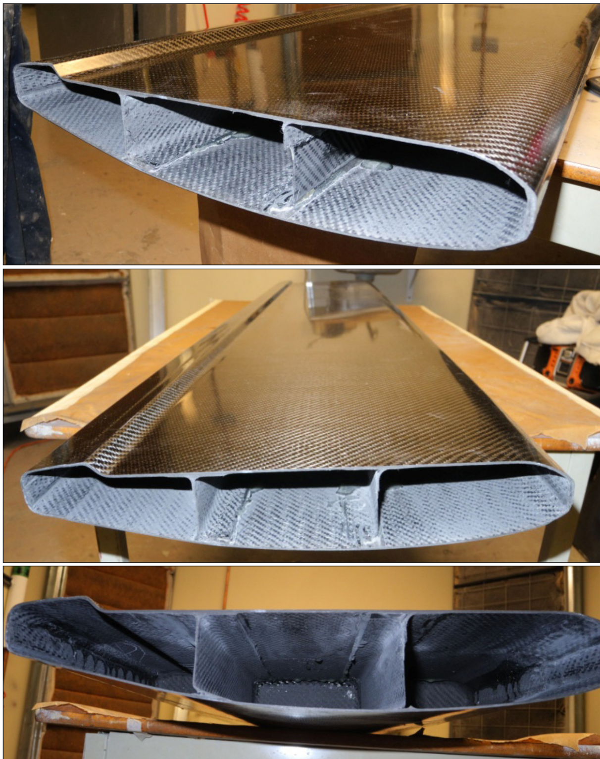
Figure 3.36 Structure après l'assemblage et la découpe du surplus de matériel
