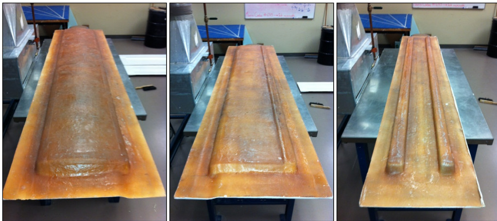
Figure 3.9 Structure des moules en fibres de verre mats/polyester pour la fabrication des longerons, de l'extrados et l'intrados
