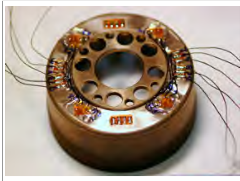
Figure 2.13 Montage des quatre rosettes de jauges de déformation sur la flexspline
