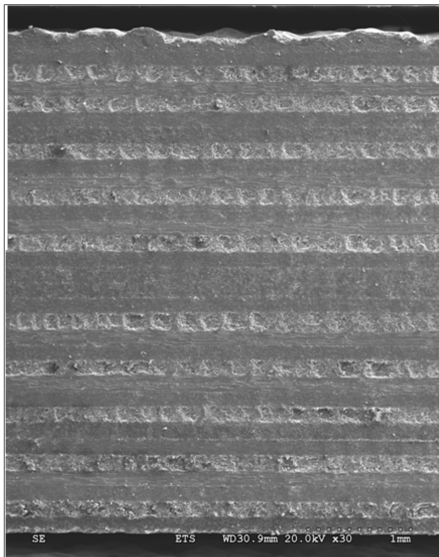
Figure 3.63 Agrandissement à 30 X de la surface machinée par l'outil C1 à la vitesse de coupe 2 pour l'avance 1
