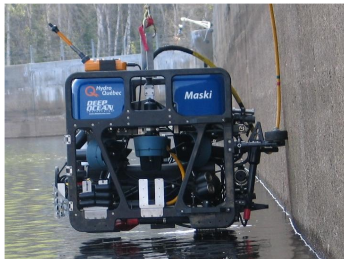
Figure 0.1 Sous-marin d'inspection Maski
