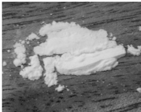
Figure 1.5 Poudre de MCPs micro encapsulés Tirée de Mehling et Cabeza (2008)
