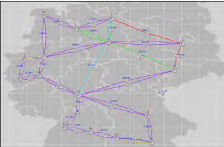
Figure 2.1 Représentation d'une solution sans filtre du réseau allemand à 17 nœuds dans le simulateur OMNeT++
