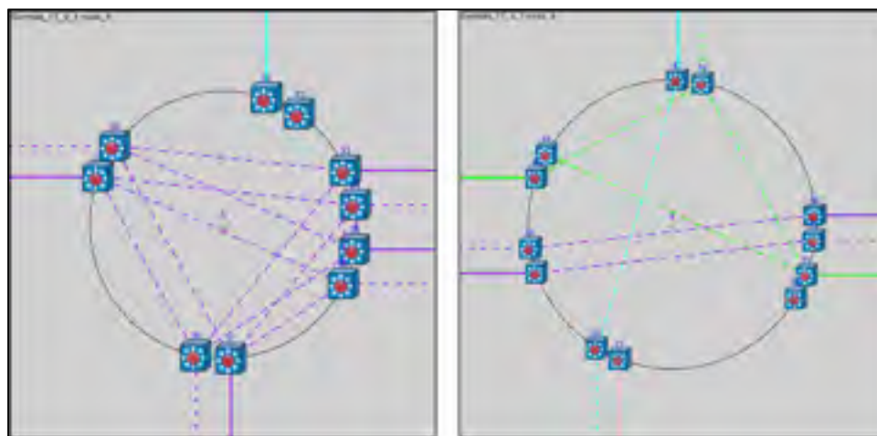
Figure 2.2 Représentation par le simulateur OMNeT++ de la connectivité interne dans les nœuds 6 (gauche) et 8 (droite) dans la solution du réseau allemand à 17 nœuds
