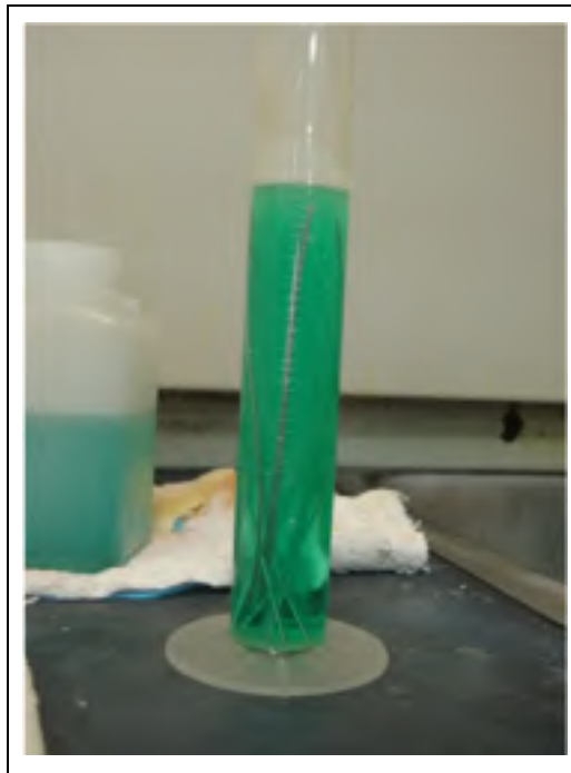
Figure 2.1 Fils immergés dans une solution de Kroll
