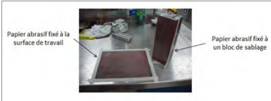
Figure 2.2 Montage utilisé pour le sablage manuel
