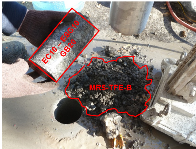
Figure 3.6 Échantillon II-B : EC-10, ESG-10 et GB-20 ; MR5-TFE-B décohésionné
