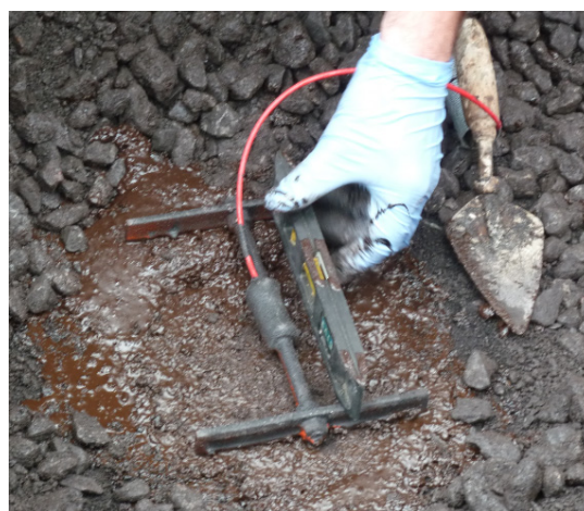
Figure 2.8 Vérification de l'horizontalité de la jauge
