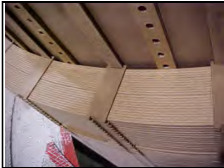
Figure 2.2 Transformateur de puissance isolation papier huile (ABB)
