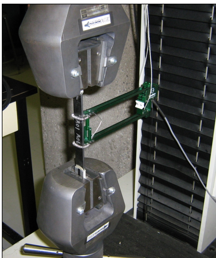
Figure 3.7 Montage utilisé pour les essais de traction
