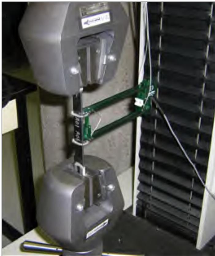
Figure 3.7 Montage utilisé pour les essais de traction
