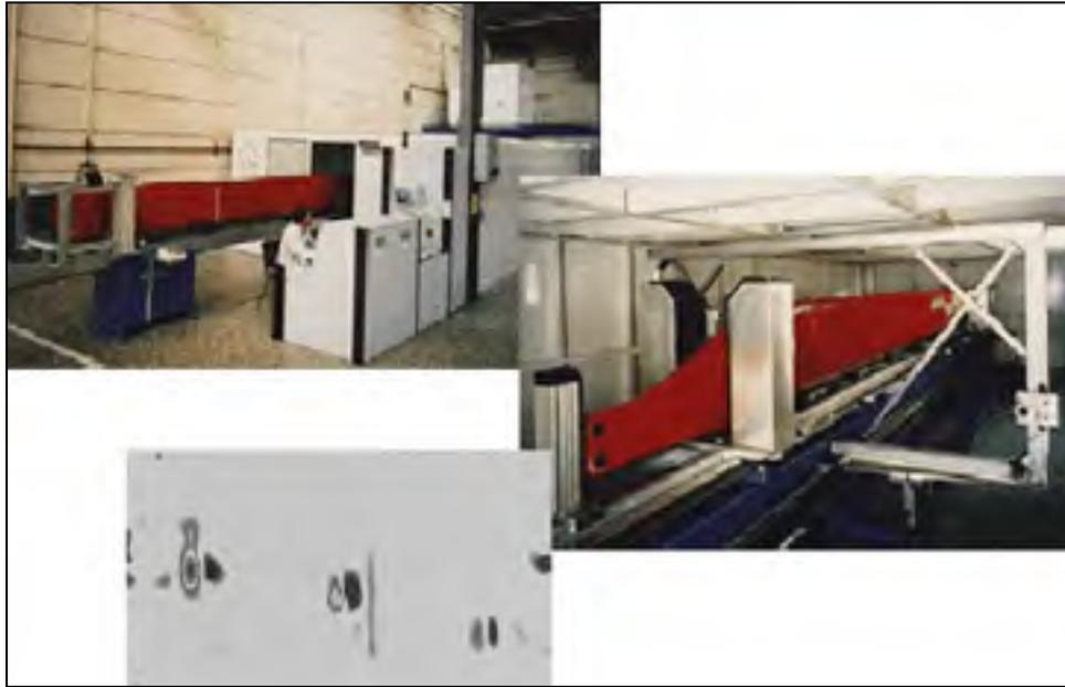
Figure 1.18 Inspection d'une pale d'hélicoptère par shearographie
