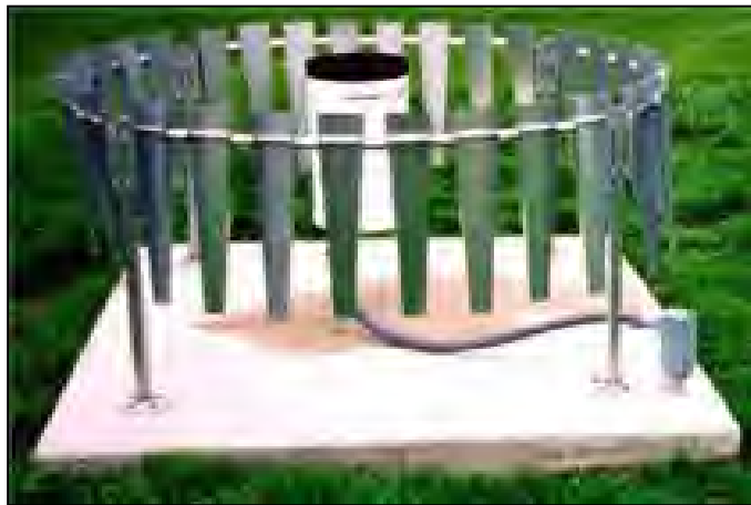
Figure 5.3 Bouclier de protection Tirée du site Internet : http://www.novalynx.com
