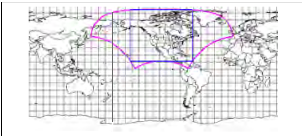
Figure 6.5 Superposition de la projection cylindrique équidistante (bleu) et conique de Lambert (magenta) sur des axes latitudes-longitudes
