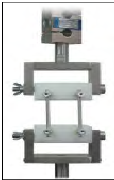
Figure 2-1 Modèle d'essai ASTM F1717-09 Tiré de Cohen, 2010
