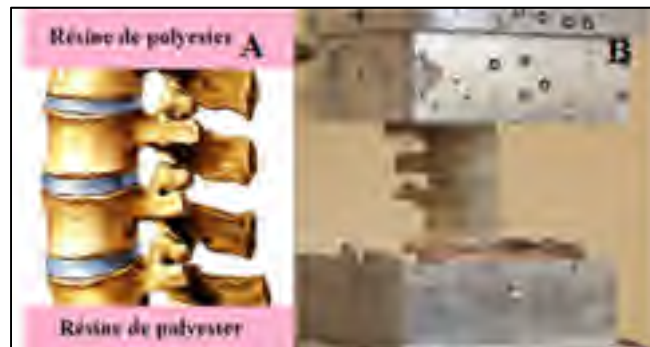
Figure 4-1 Spécimen installé dans la résine de polyester: A) schéma et B) spécimen synthétique dans le banc d'essai Schéma modifié de Kamina et Netter, 2009, p.148
