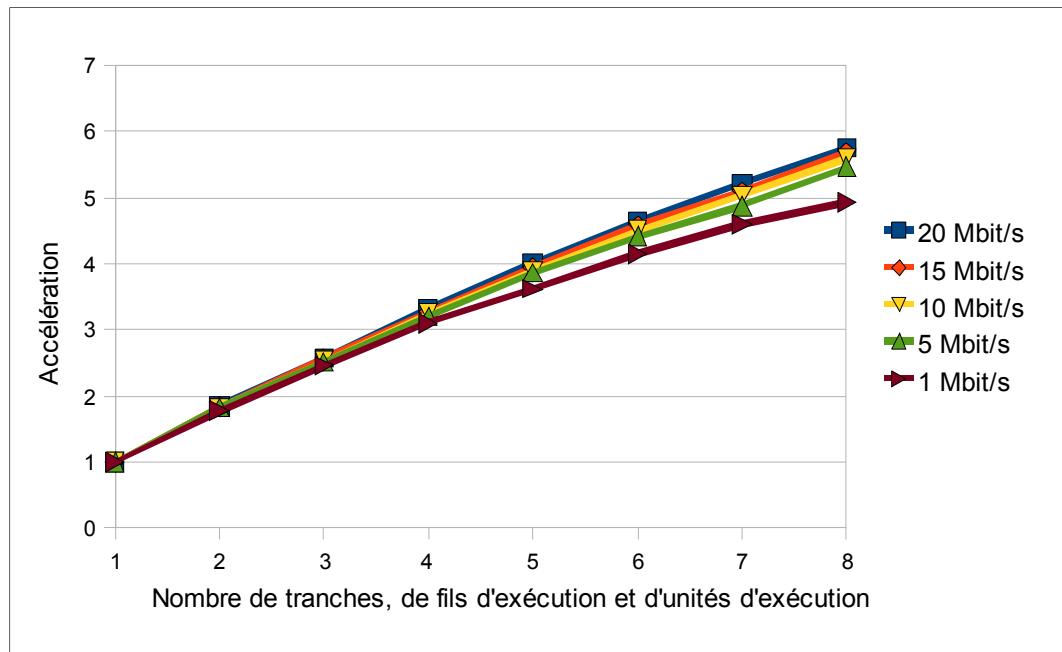
Figure 4.9 Accélération de l'approche d'Intel (modifié) avec filtre parallèle en fonction du nombre de fils pour des débits de 1, 5, 10, 15 et 20 Mbit/s.
