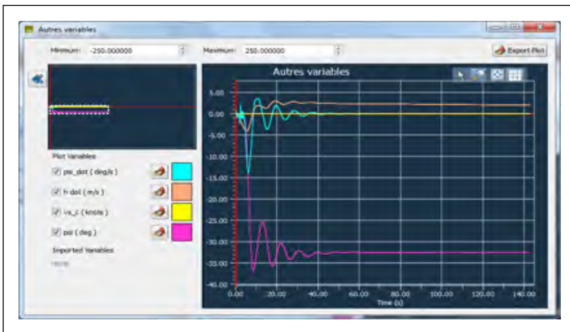
Figure 6.11 Évolution d'autres variables (implémentation de la loi de commande de l'axe latéral uniquement avec les autres axes pris par défaut)
