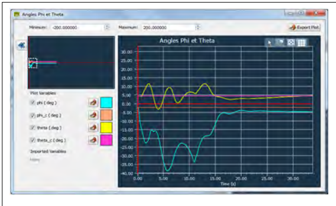
Figure 6.12 Évolution des angles \phi et \theta (implémentation des lois de commande de l'axe latéral et de lacet avec les autres axes pris par défaut)
