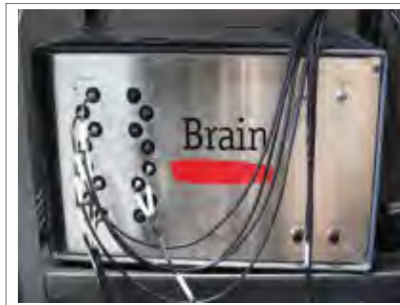
Figure 2.2 Prototype NIRS 4 sources, 8 détecteurs
