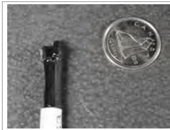
Figure 2.9 2 ième type de connecteur personnalisé vu de côté
