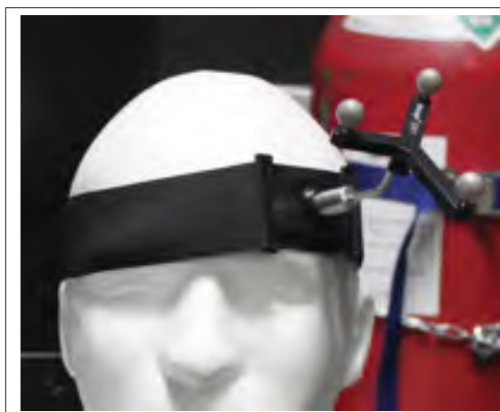
Figure 2.21 Référentiel à poser sur la tête pour le recalage
