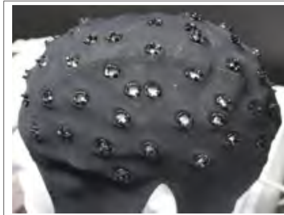
Figure 2.13 Casque utilisant une configuration hexagonale avec le deuxième type de connecteur
