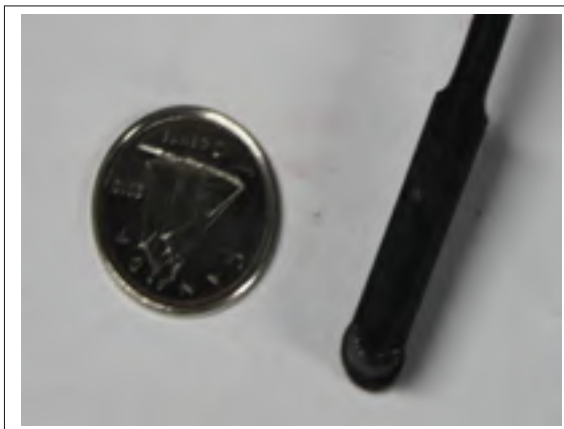
Figure 2.10 3 ième type de connecteur personnalisé vu du dessus
