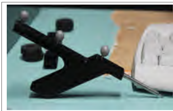
Figure 2.20 Pointeur servant à au recalage
