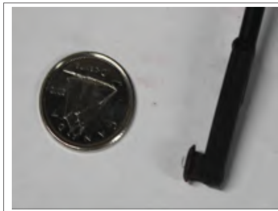
Figure 2.11 3 ième type de connecteur personnalisé vu de côté
