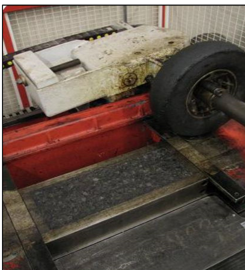
Figure 3.8 Compacteur de plaque LCPC Tirée de Lacroix (2009, p. 15)
