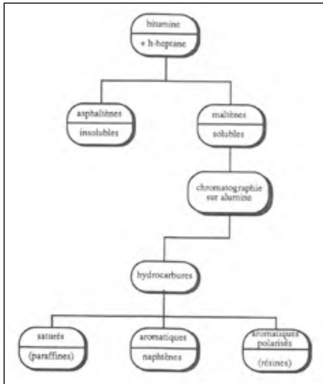
Figure 1.3 Structure des bitumes Tirée de Lelièvre (1994, p. 25)
