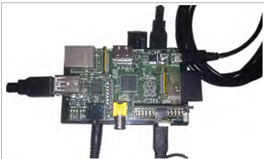
Figure 1.11 Assemblage de l'UCT (vue de dessus)
