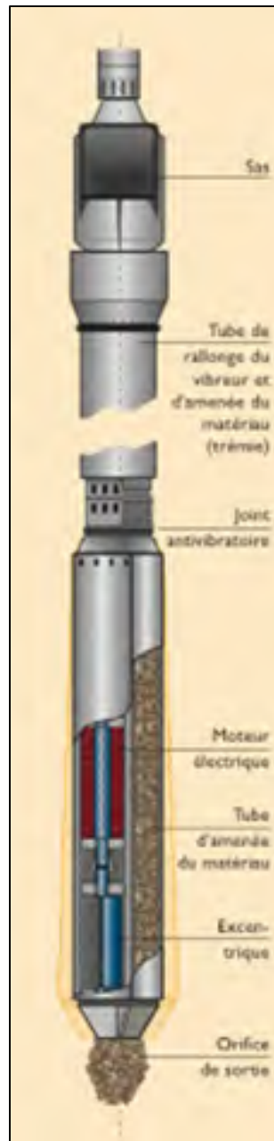
Figure 4.3 Vibreux à sas, servant à l'installation des colonnes ballastées par « bottom feed » Tirée de Keller Group (2010)
