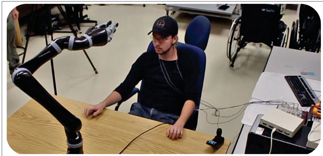
Figure 5.2 Contrôle de Jaco par canaux EMG
