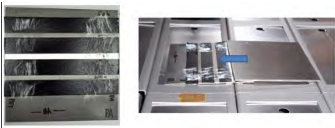
Figure 2.10: Méthode de préparation des échantillons pour le vieillissement accéléré
