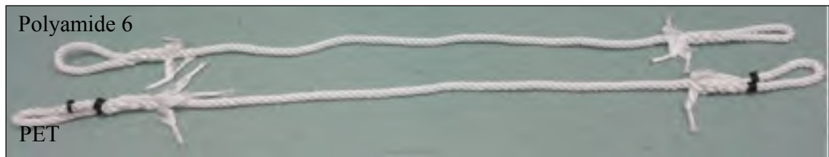
Figure 2.1 : Corde de polyamide 6 et de PET
