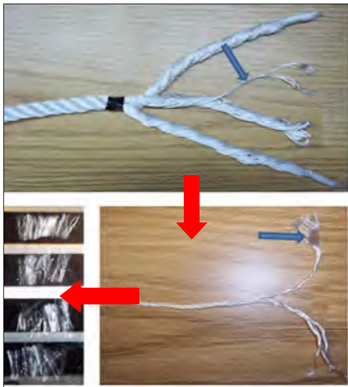
Figure 2.9 : Méthode de préparation des échantillons pour le vieillissement naturel
