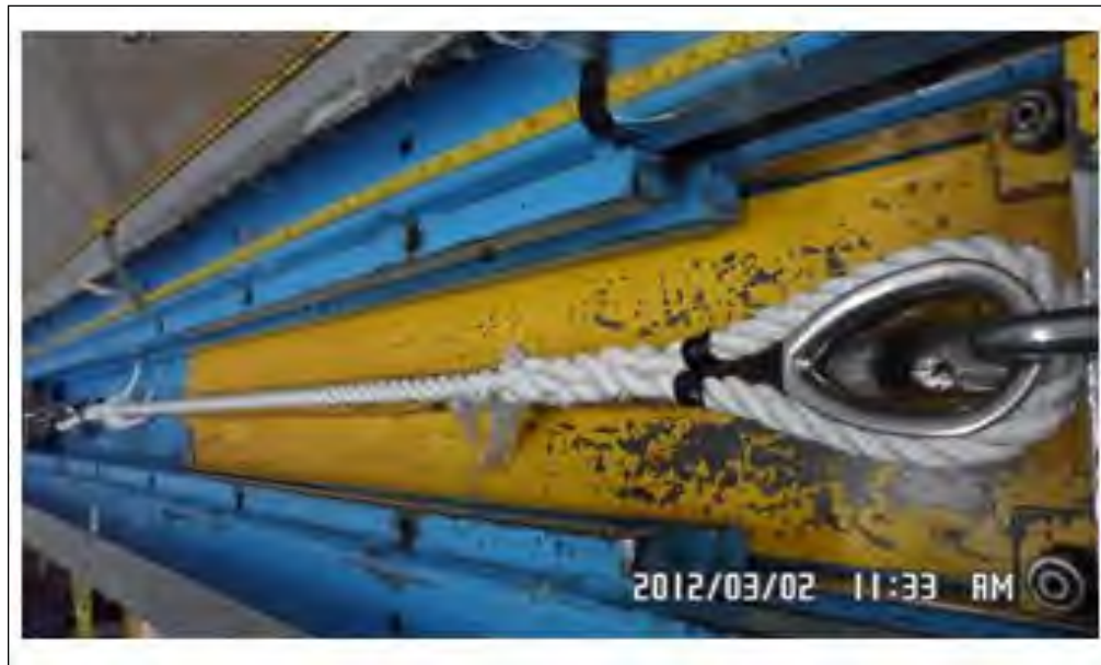
Figure 2.5: Banc d'essai des propriétés mécaniques (traction) chez l'entreprise Cordage Barry
