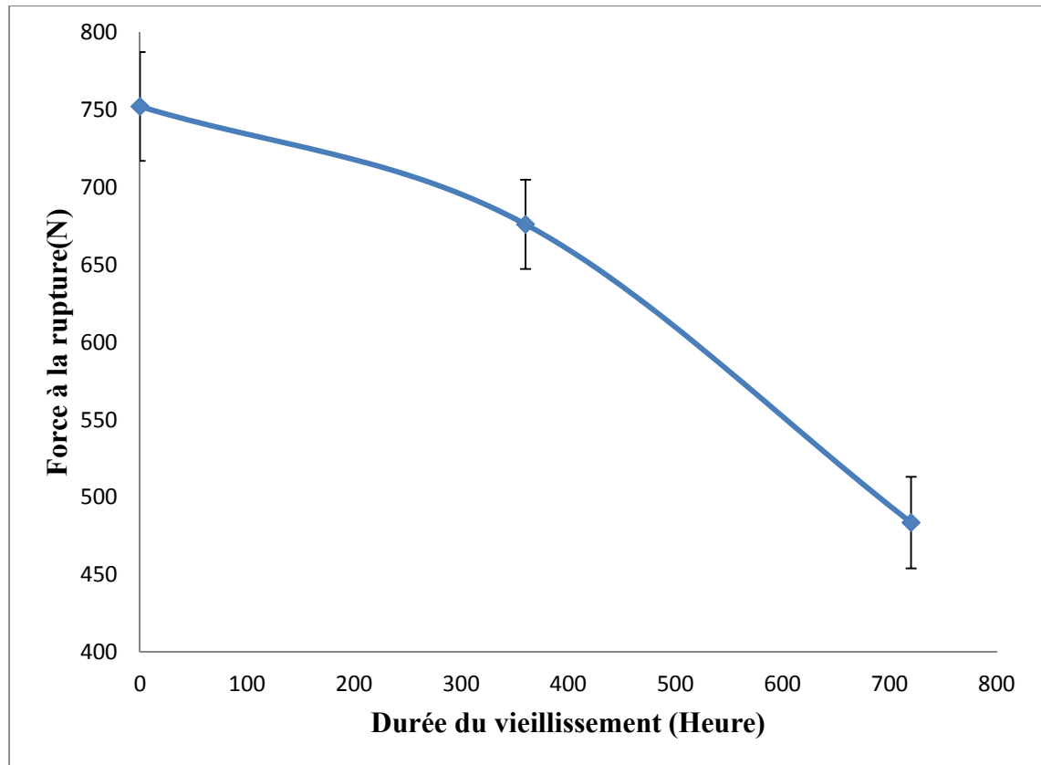
Figure 4.3: Force de rupture en fonction de la durée de vieillissement en laboratoire des brins de PET
