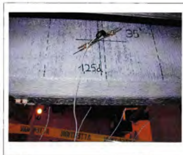
Figure 5.7 Jauge de déformation collée en surface (JBB-surface) – Spécimen S0-1L.
