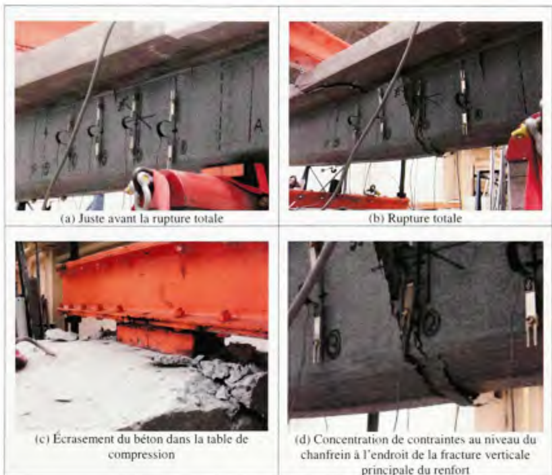
Figure 5.30 Modes de rupture – Spécimen S1-1L.
