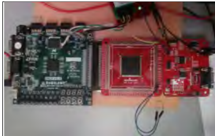
Figure 3.4 Montage avec une carte Nexyx II (testeur) et une Sparkfun (circuit sous test)
