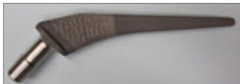
Figure 3.18 Prototype de la prothèse avec revêtement en titane poreux fabriqué par electron beam melting .
