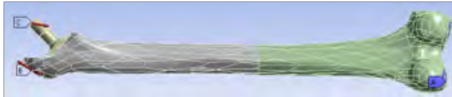
Figure 4.2 A) Zone d'encastrement aux condyles fémoraux B) Force des abducteurs : 871N C) Force de contact à l'articulation : 1 948N.
