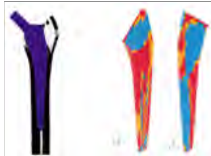
Figure 1.10 Implantation de la prothèse dans le fémur (gauche), Zones sans croissance de l'os dans la prothèse en bleu (droite). Adaptée de (Fernandes et al., 2002)
