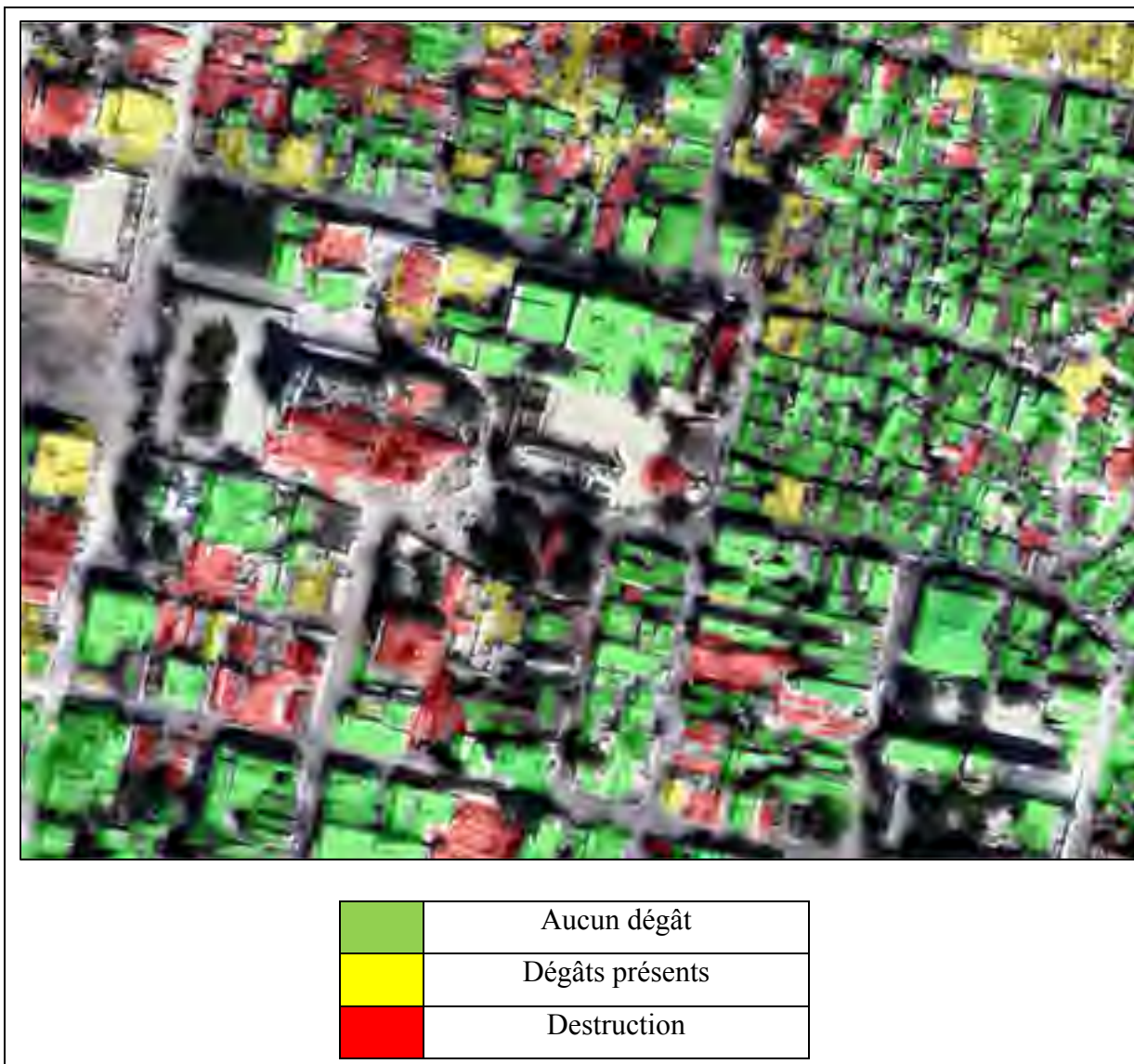
Figure 4.23 Dégâts sur les bâtiments - référence
