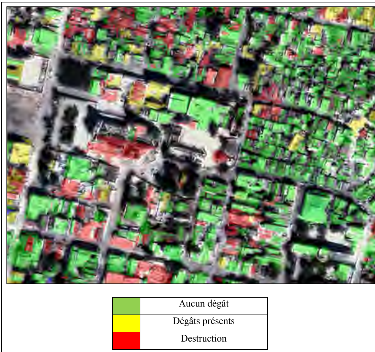
Figure 4.25 Dégâts sur les bâtiments - résultats
