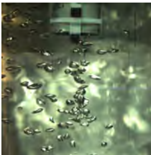
Figure 4.6 Photo de type «Taille de bulle» tiré de l'expérience #6 en mode jet libre pour un ratio G/L de 0,08
