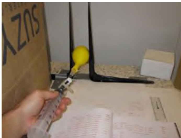
Figure-A III-1 Montage pour l'établissement de la courbe du diamètre du ballon en fonction du volume de gaz
