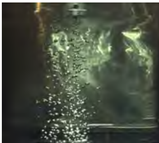
Figure 4.5 Photo de type «Panache de bulle» tiré de l'expérience #6 en mode jet libre pour un ratio G/L de 0,08
