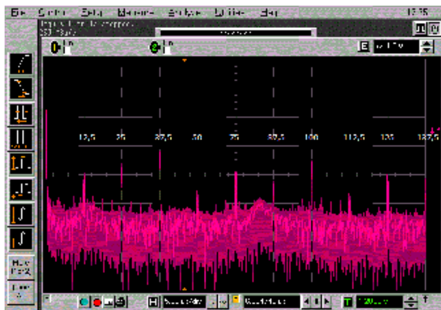
Figure 2.13 FFT de V_{DD} dans le mode fonctionnel avec commutation pour une fréquence de 75MHz
