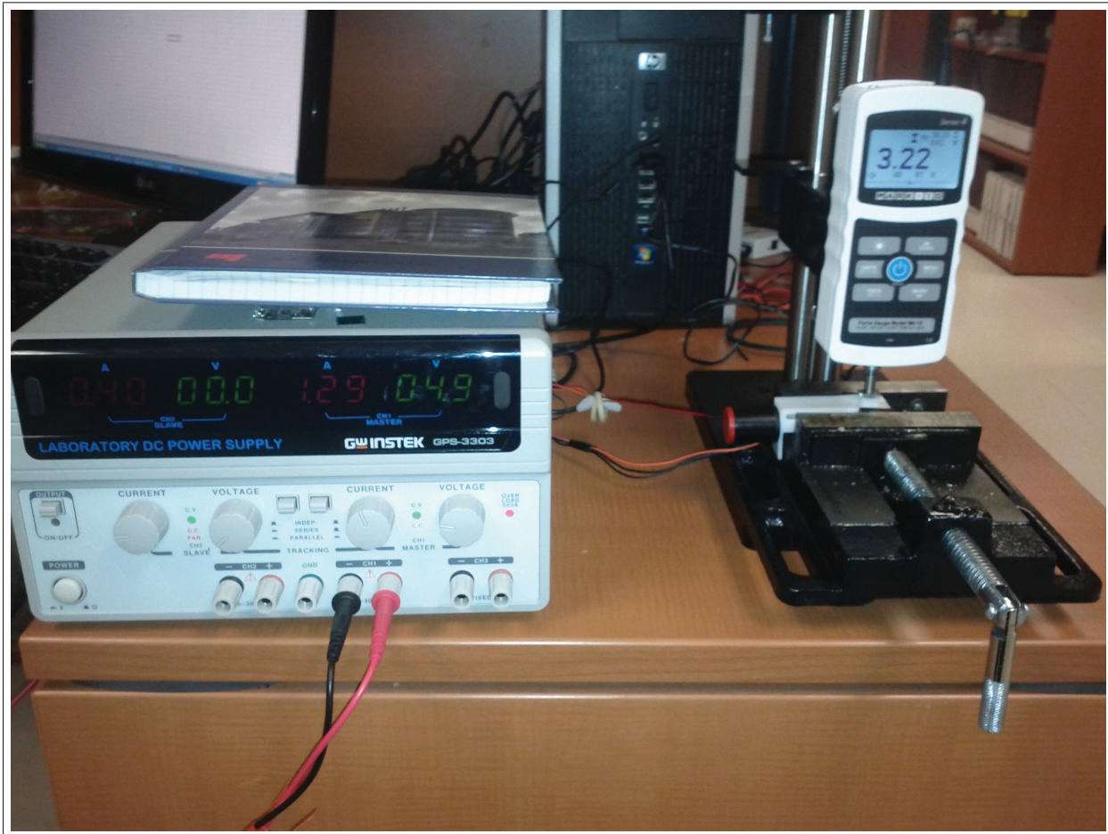
Figure 5.11 Montage pour effectuer le test de force
