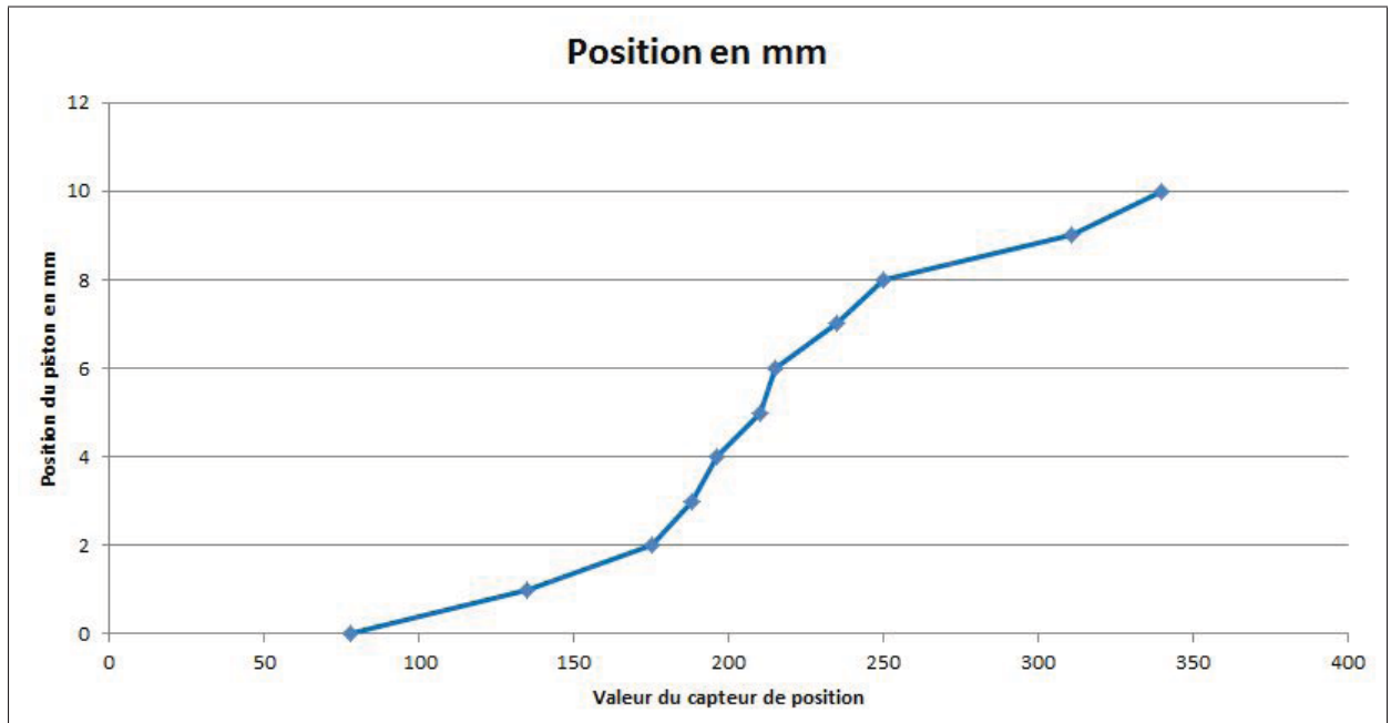
Figure 5.5 Graphique représentant la valeur du capteur par rapport à la position du piston
