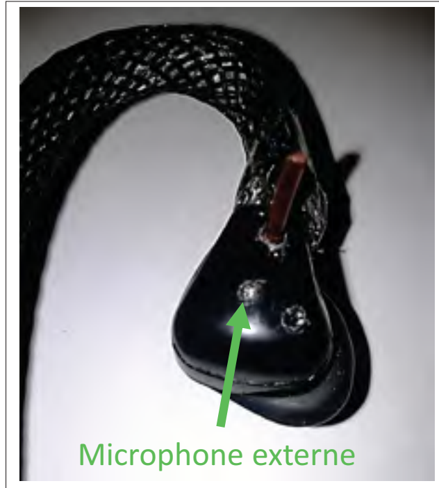
Figure 1.3 Microphone externe placé sur la paroi externe de l'oreillette DPOAE
