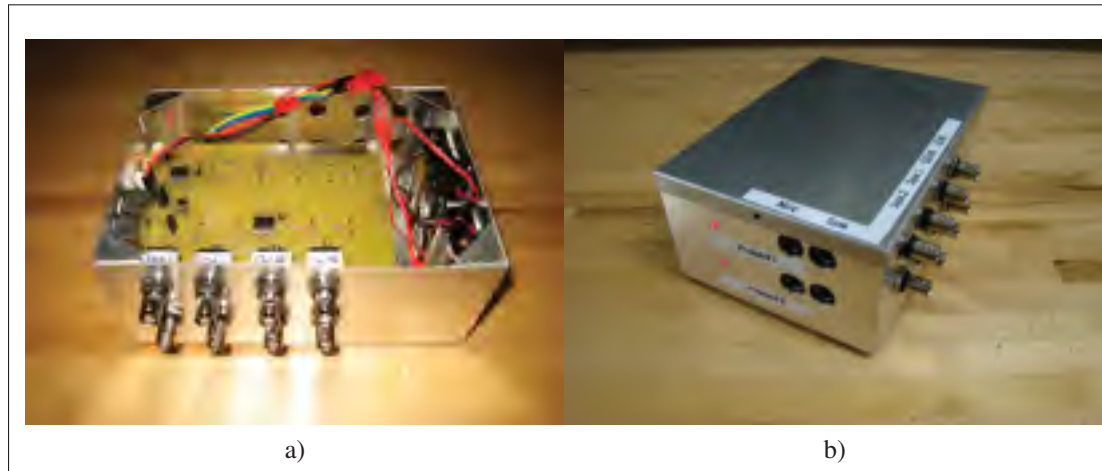
Figure 1.6 Prototype d'amplificateur-conditionneur (2 canaux de microphones internes amplifiés)
