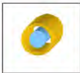
Figure 4.3 Système à électrodes en configuration cylindre-cylindre Adaptée de Vincent (2002, p. 40)
