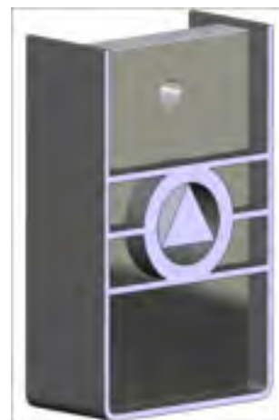
Figure 4.9 Vue en coupe verticale de l'échantillon et des électrodes
