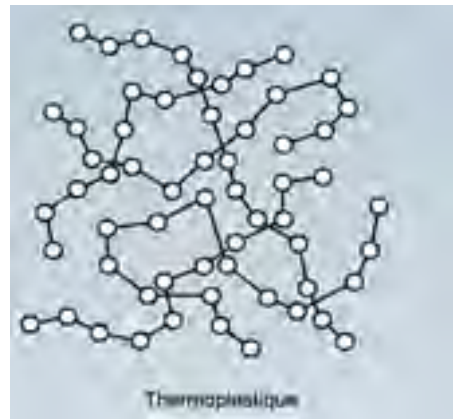
Figure 1.6 Configuration moléculaire schématisée d'un thermoplastique Adaptée de Paroli et al. (1999)
