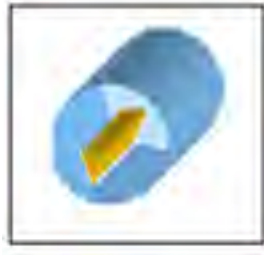
Figure 4.4 Système à électrodes en configuration couteau-cylindre Adaptée de Vincent (2002, p. 40)
