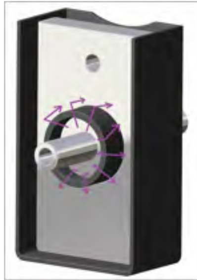
Figure 5.3 Chemin emprunté par le courant pour la formation d'arcs électriques lors des tests à tension maximale
