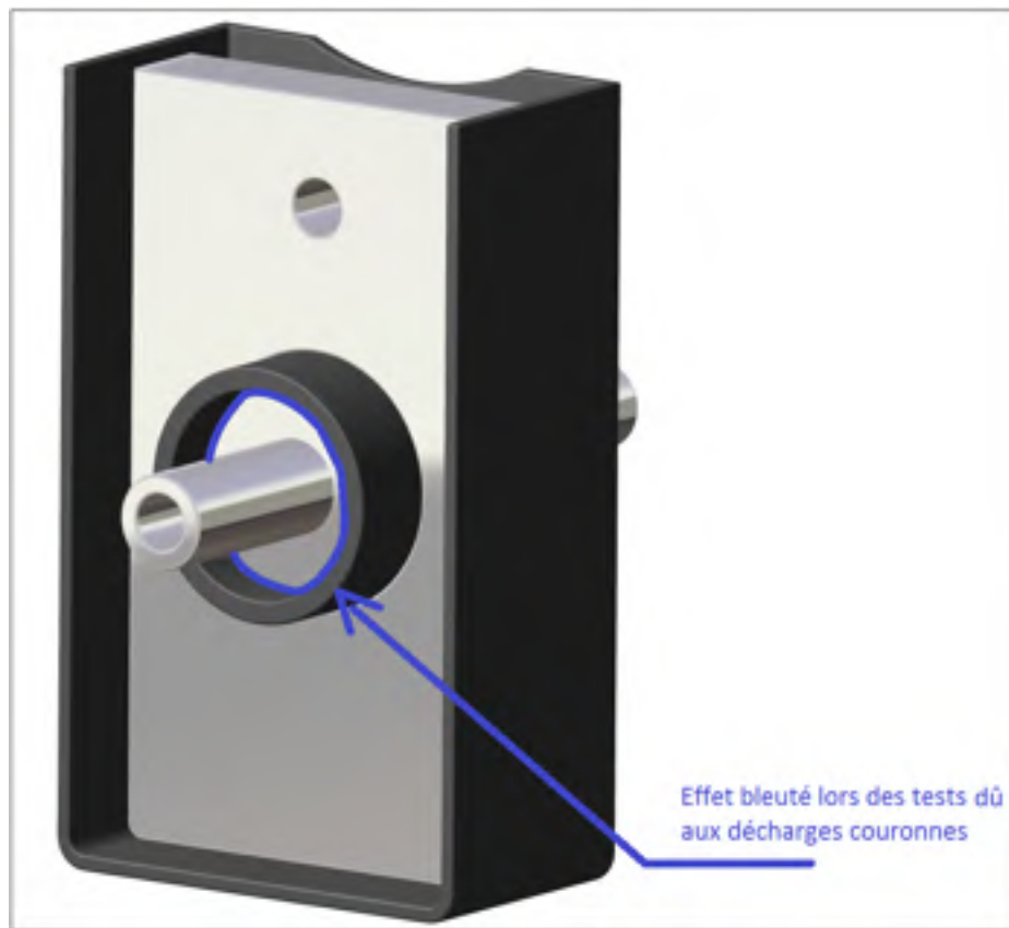
Figure 5.2 Mise en évidence des décharges couronnes lors des tests
