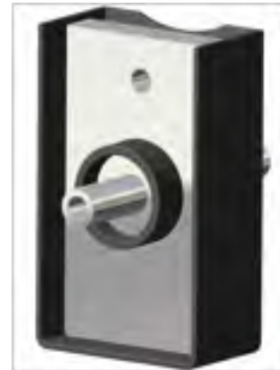
Figure 4.7 Modélisation de l'échantillon et des électrodes assemblés
