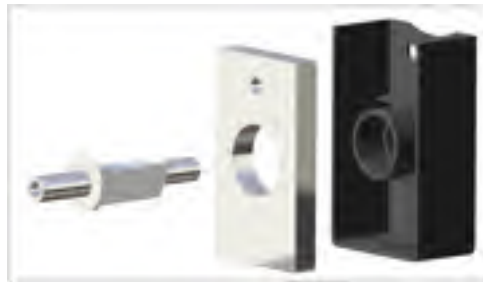
Figure 4.6 Modélisation de l'échantillon et des électrodes désassemblés
