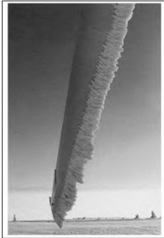
Figure 2.1 Pale d'une éolienne givrée. Tirée de Tammelin et al. (1998, p. 6)
