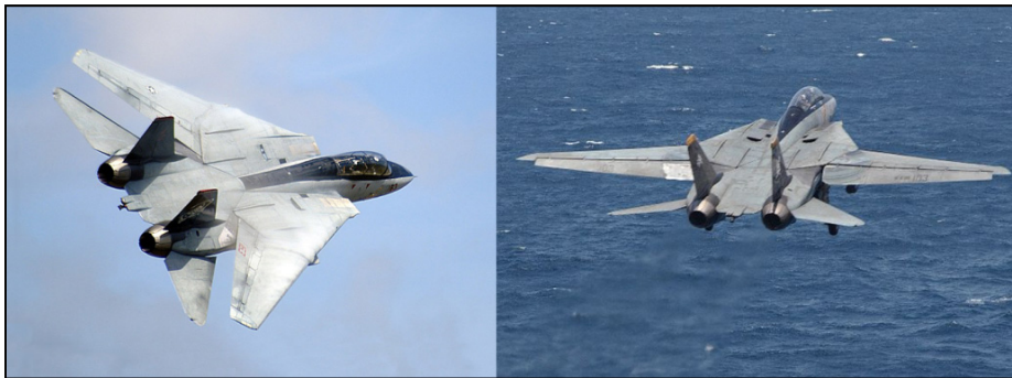
Figure 2.3 Concept de variation de l'angle de balayage (F-14 Tomcat) Par US Navy (2004) du domaine public
