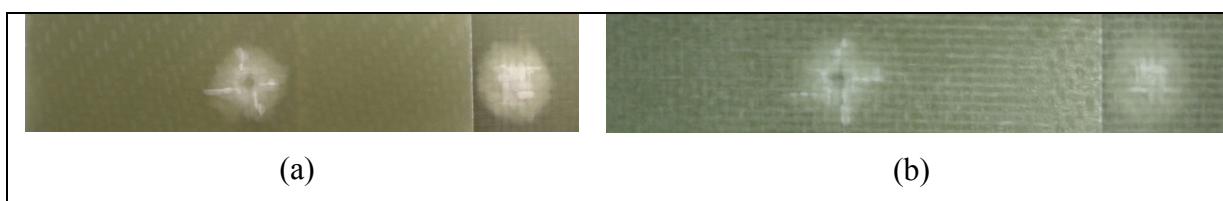
Figure 5.4 Résultats d'un test d'impact sur les composites infusés avec du vinylester et des renforts de TG09T (verre E; sergé; 9 oz/vg 2 ), en (a) qualité de fabrication supérieure avec un volume de fibre de 57% et en (b) qualité de fabrication standard avec un volume de fibre de 52%.
