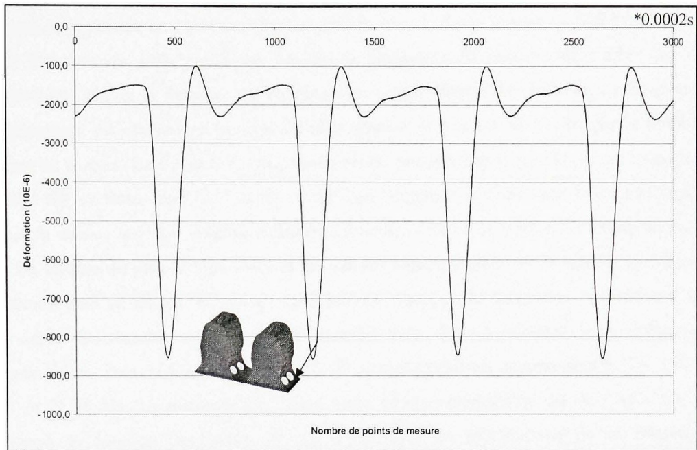
Figure 4.6 Déformation de la jauge 2 de la roue 9, avec une vitesse de 200 tr/min.
