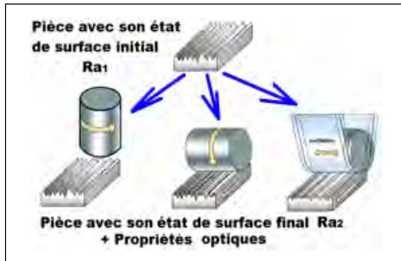
Figure 1.2 Opérations de polissage
