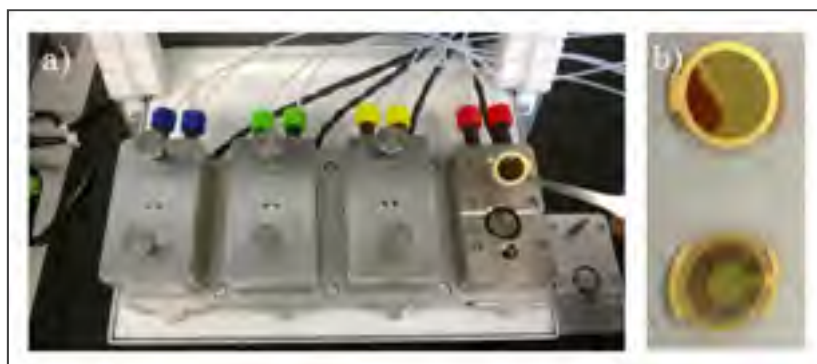
Figure 3.4 Le système E4 de Q-Sense (a) permet de suivre en temps réel la fabrication en parallèle de quatre surfaces sur ses capteurs (b)
