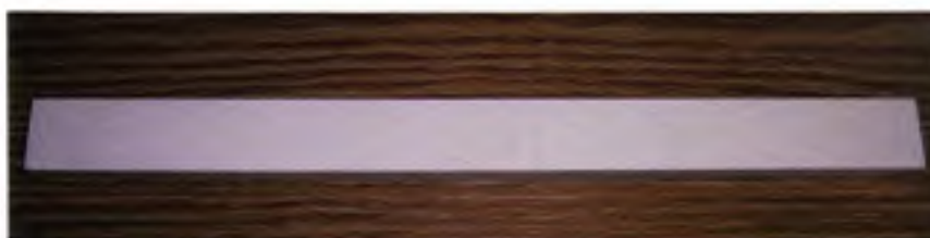
Figure 2.10 Tuile de calibration Spectralon.
