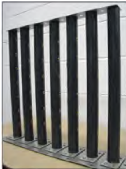
Figure 6.7 Rampe d'injection E3
