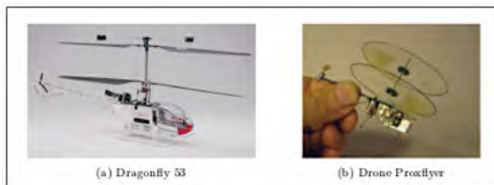
Figure 2.8 Exemples de drones à rotors coaxiaux à usage interne Tirée de A. Drouot (2013)
