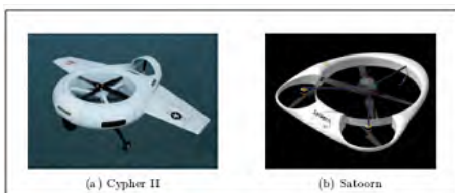
Figure 2.10 Exemples de drone à rotors coaxiaux à carène courte Tirée de A. Drouot (2013)
