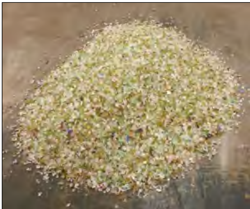
Figure 1.1 Exemple de verre de type mixte concassé
