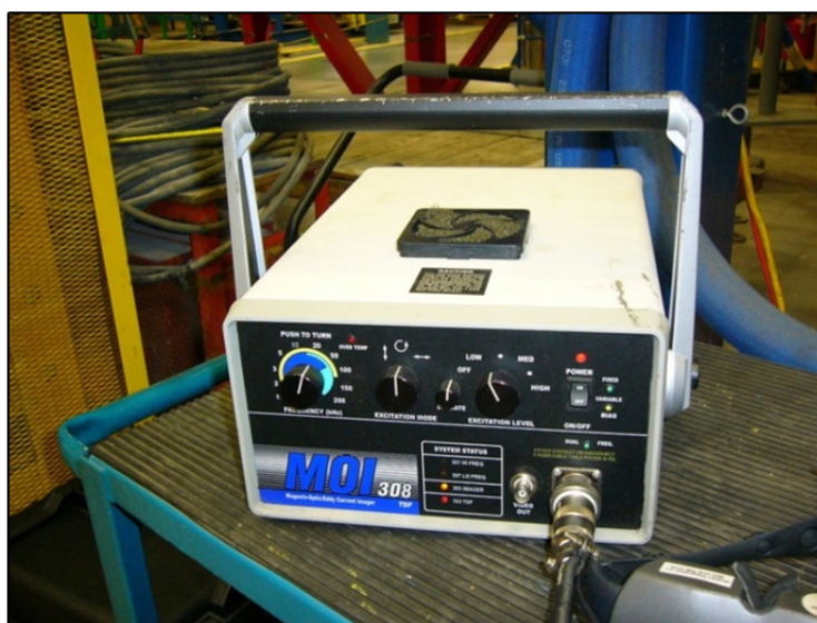
Figure 4.9 Appareil MOI 308/37/TDF, unité de contrôle
