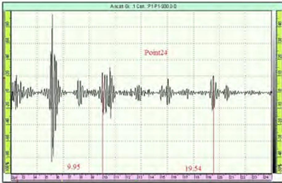
Figure 5.19 Mesure de la vitesse transversale sur le point 24
