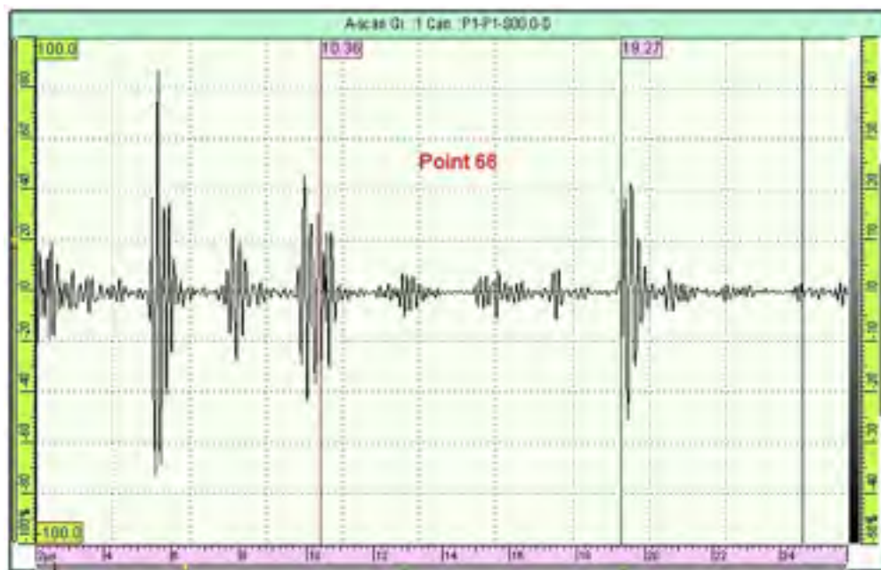
Figure 5.18 Signaux importants indiqués par les curseurs
