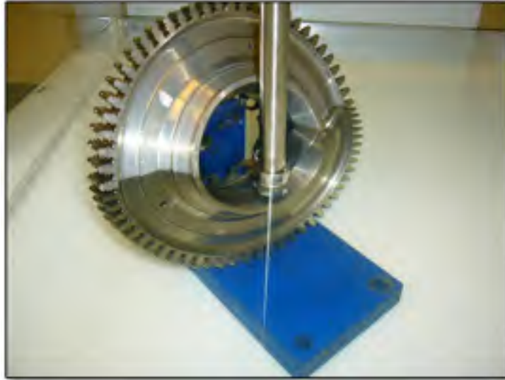
Figure 5.24 Disque de Waspaloy dans le bassin d'eau
