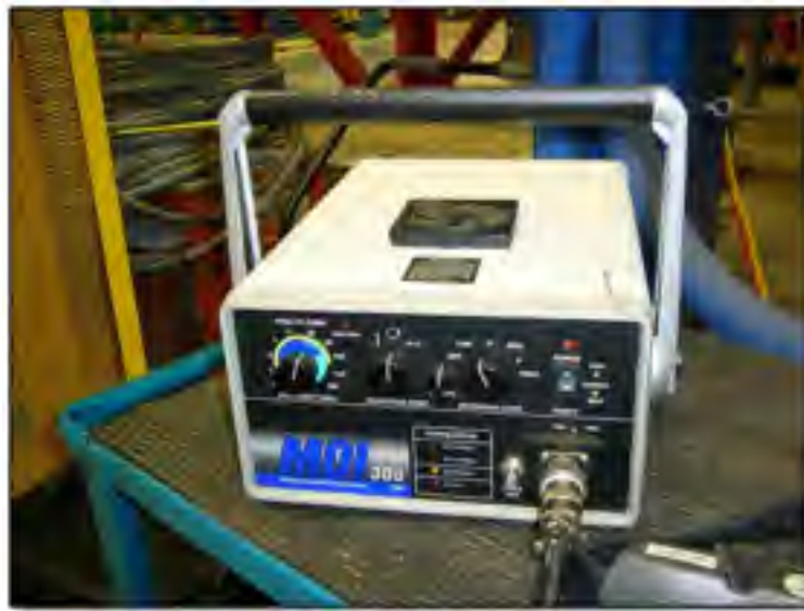
Figure 4.9 Appareil MOI 308/37/TDF, unité de contrôle
