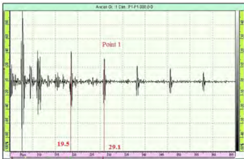
Figure 5.17 Mesure de la vitesse transversale sur l'étendue 64.68 \mu s
