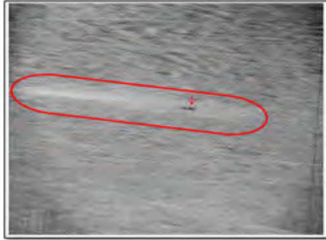
Figure 1.6 White spot discret et la fissure associée Tirée de (Donachie, 2002c, p. 65)
