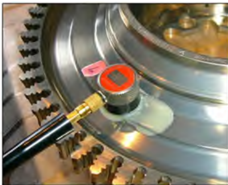
Figure 5.10 Disque de Waspaloy avec la sonde V153
