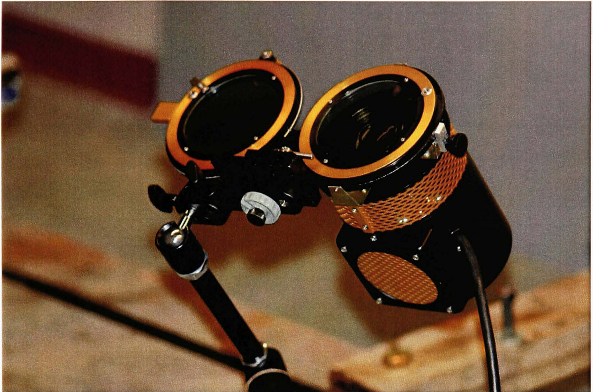
Figure 3.8 Polariscope par réflexion.
