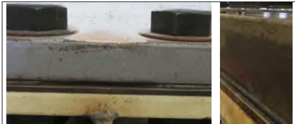
Figure-A II-1 Glissement de la paroi d'acier, banc d'essai 2
