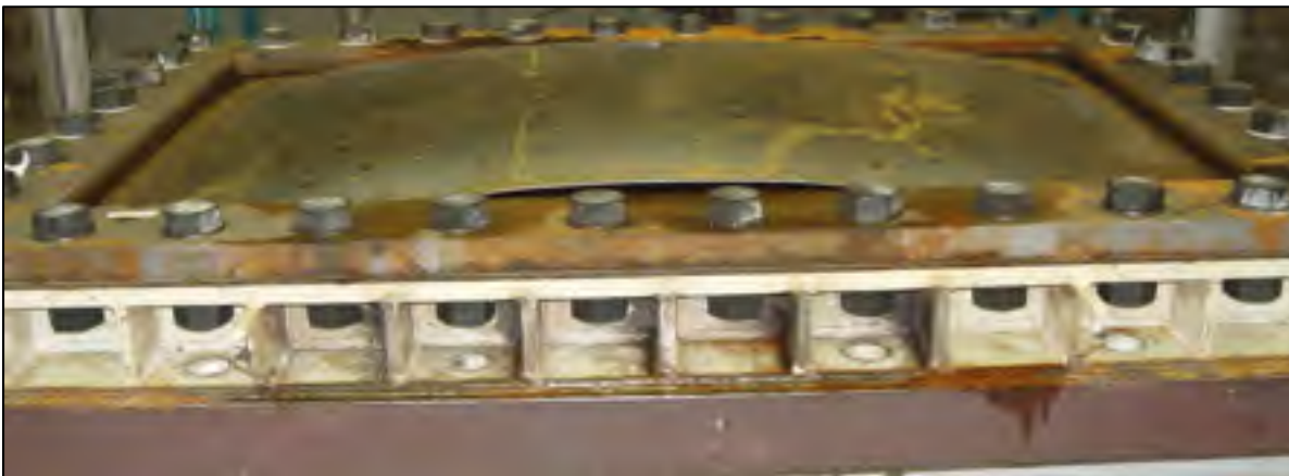
Figure 5.2 Déchirement en traction (mode II), essai 5
