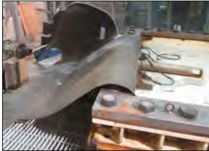
Figure 5.3 Déchirement de trois côtés de la paroi d'acier, essai 6
